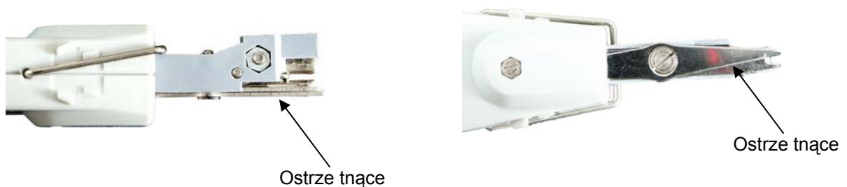
Rys. 2. Widok głowicy noża z boku i od strony ostrza tnącego
