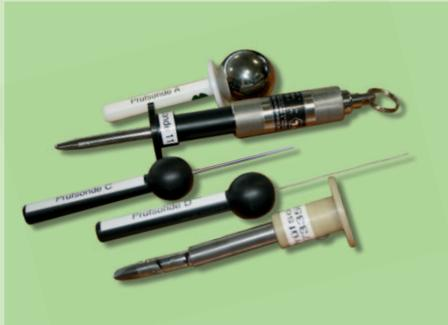
Prüfsonden nach DIN EN 60529
