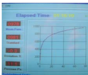
Krzywa temperaturowa podczas prób zgodności z normą DIN 4102
