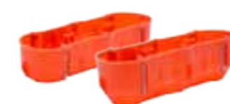
PP-F3x60PŁ.REG-P / PP-F3x60GŁ.REG-P Puszka instalacyjna, końcowa, potrójna z wkrętami, do ścian pustych, płytka 3xØ60, głębokość: 45mm/ głęboka 3xØ60, głębokość: 60mm
