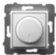
ŁP-8UL2/m/00 2114 Ściemniacz uniwersalny, zakres obciążenia: GLS 10-250W, CFL 5-75W, LED 0-100W, funkcja wyłącznika czasowego i „time to bed”
