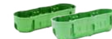
PP-F3x60PŁ-N / PP-F3x60GŁ-N Puszka instalacyjna, końcowa, potrójna, z wkrętami, płytka 3xØ60, głębokość: 45mm/ głęboka 3xØ60, głębokość: 60mm
