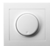
ŁP-8WL2/00 Ściemniacz uniwersalny, zakres obciążenia: GLS 10-250W, CFL 5-75W, LED 0-100W, funkcja wyłącznika czasowego i „time to bed” 1749
